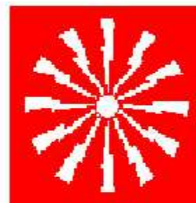
PULSANTE DI ALLARME ANTINCENDIO
